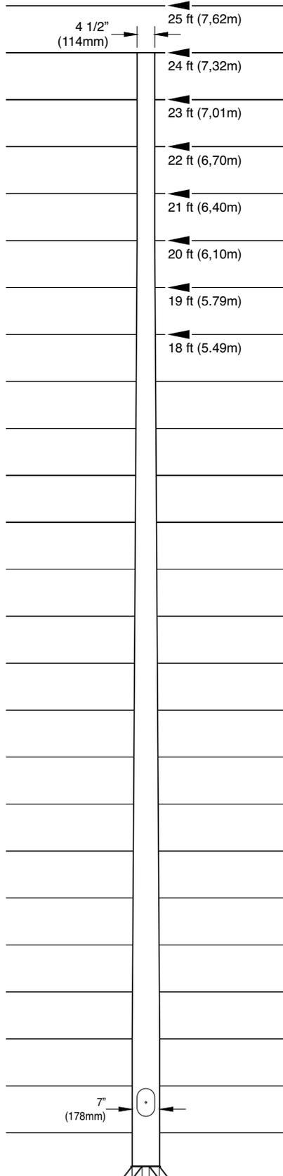
**Fût :** Le fût repoussé conique sans joint **A81 AB 745** est fabriqué à partir d'un alliage d'aluminium 6063 et soudé à une plaque d'ancrage. L'assemblage final est traité thermiquement pour produire une trempe T6. Le diamètre extérieur de la base du fût est de 7" (172mm). Le diamètre extérieur supérieur est de 4 1/2" (114mm).
